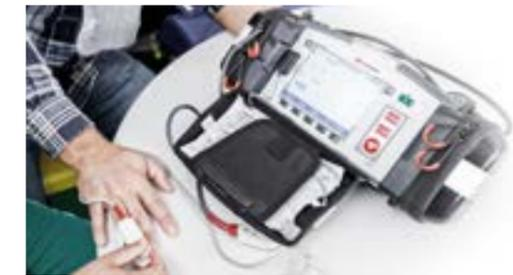
Das integrierte Pulsoxymeter (optional) ermöglicht die Überwachung von Sauerstoffsättigung, Pulsfrequenz und Plethysmogramm.
